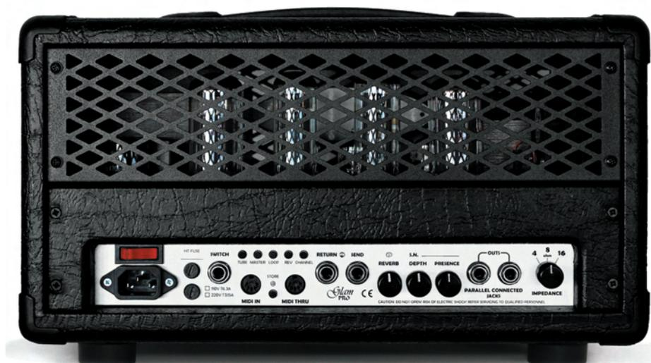
vo selettore d'impedenza a 4, 8 e 16 ohm) le connessioni per il send/return, la presa footswitch e cinque pulsantini per il richiamo manuale delle funzioni; da qui è possibile selezionare il canale, attivare/disattivare il riverbero, aprire/chiedere il
