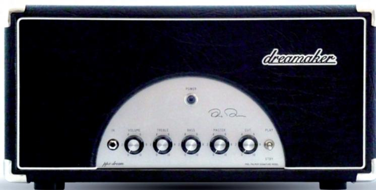
le 12AX7 sul pre e quattro valvole EL84 sul finale. Dispone di loop effetti bufferizzato bypassabile e selettore +4/-10 dB con impedenza d'uscita selezionabile tra 8 e 16 Ohm. Le dimensioni sono 66x24x22 cm e il peso 15,4 kg.
